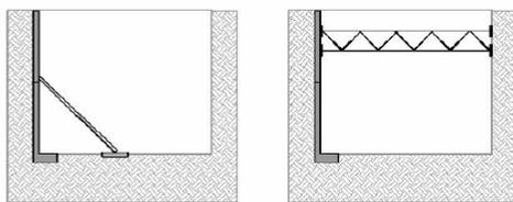
**Etapas de excavación con pilotes de anclaje**
